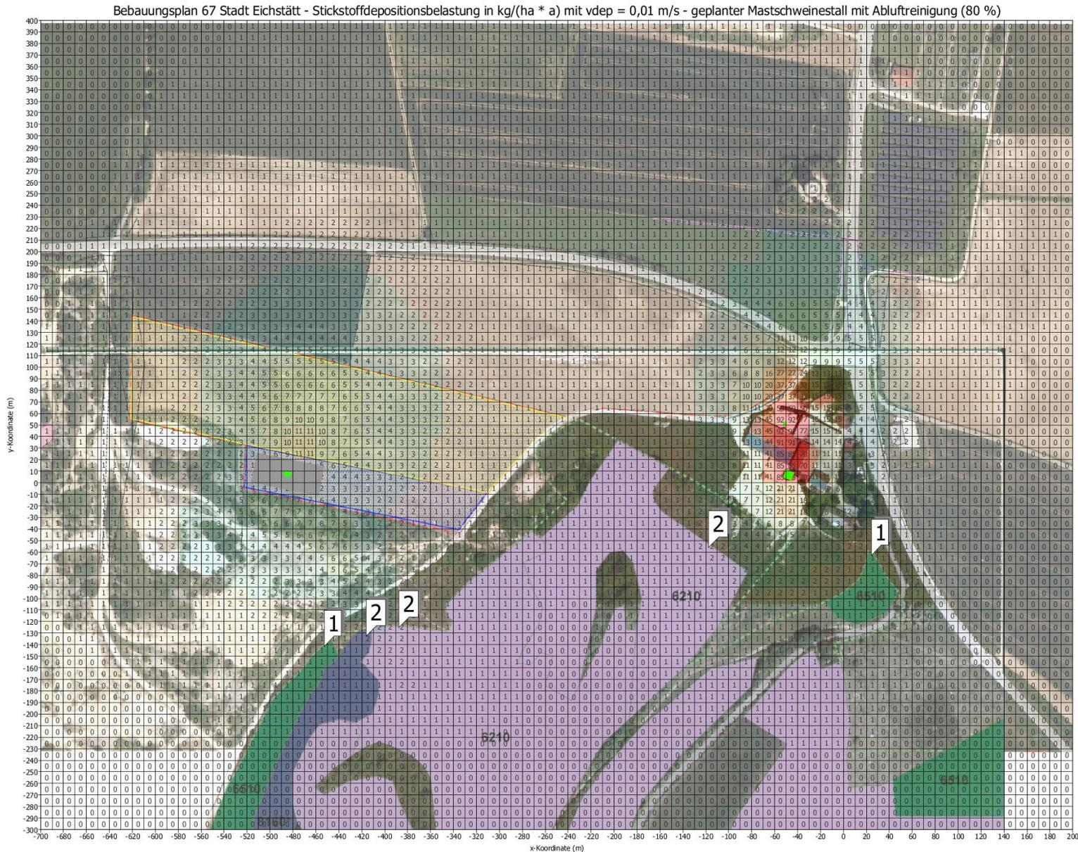
**Abbildung 16: N-Depositionsbelastung durch die bestehende Pferdehaltung und den geplanten Mastschweinestall mit Abluftreinigung (85 % Ammoniakminderungsgrad) mit  $v_{dep} = 0,01$  m/s**
