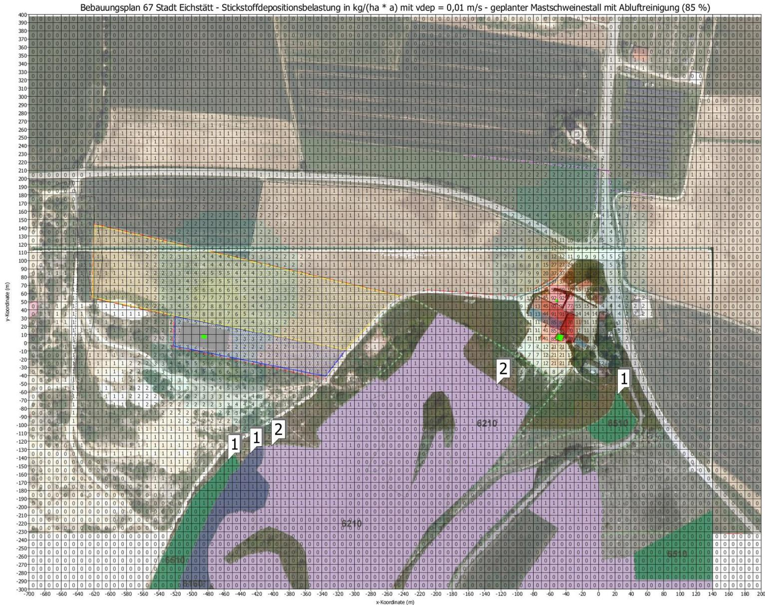
**Abbildung 17: N-Depositionsbelastung durch die bestehende Pferdehaltung und den geplanten Mastschweinestall mit Abluftreinigung (90 % Ammoniakmin-
